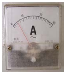
รูปที่ 57 เข็มของแอมป์มิเตอร์จะต้องแสดงค่ากระแสไฟฟ้าตามค่าที่ระบุในแผ่นป้ายเนมเพลท
