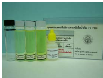
รูปที่ 76 ชุดทดสอบคลอรีนอิสระคงเหลือในน้ำดื่ม (ว 720 )
